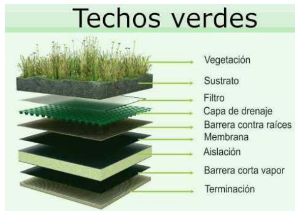
Ilustración 15: Techos verdes. Fuente: ingenieriaambiental.net
