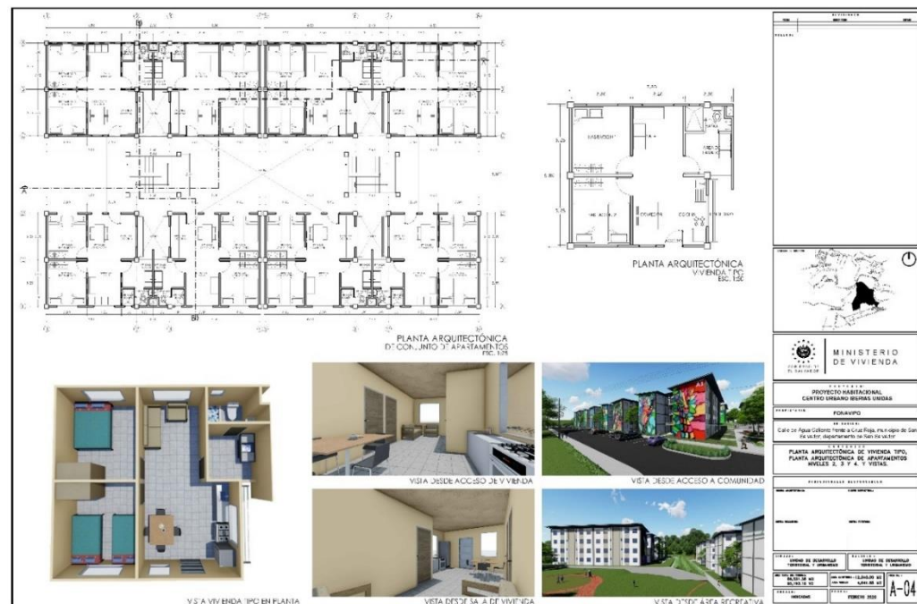
Proyecto habitacional Iberias Unidas. Planta tipo de vivienda equiparable a VIS planteado. Fuente: MIVI. FONAVIPO
