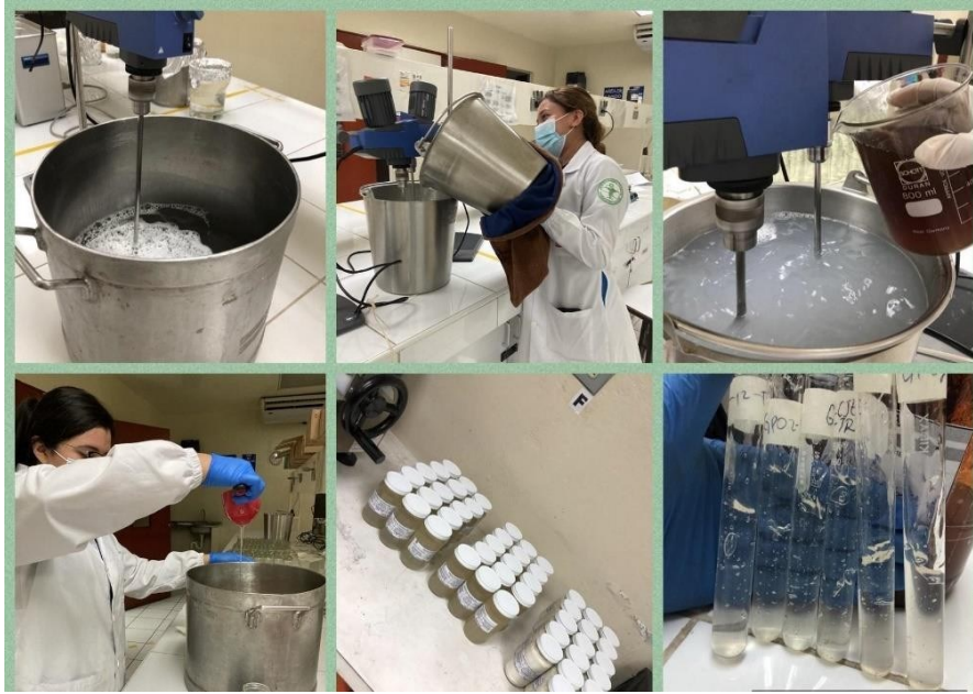
Figura N°9: Elaboración de lote de laboratorio para el estudio de Estabilidad Preliminar del Champú anticaspa
