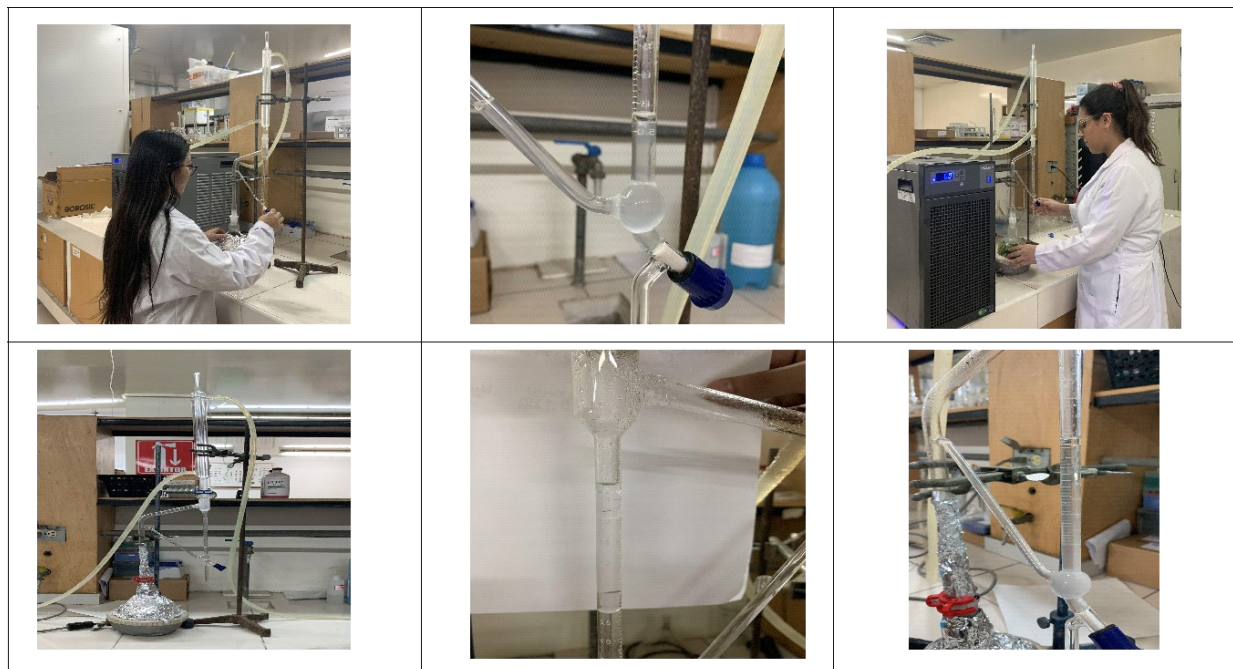
Fig 8. Puesta a punto del método Clevenger con hojas del "Limón".
