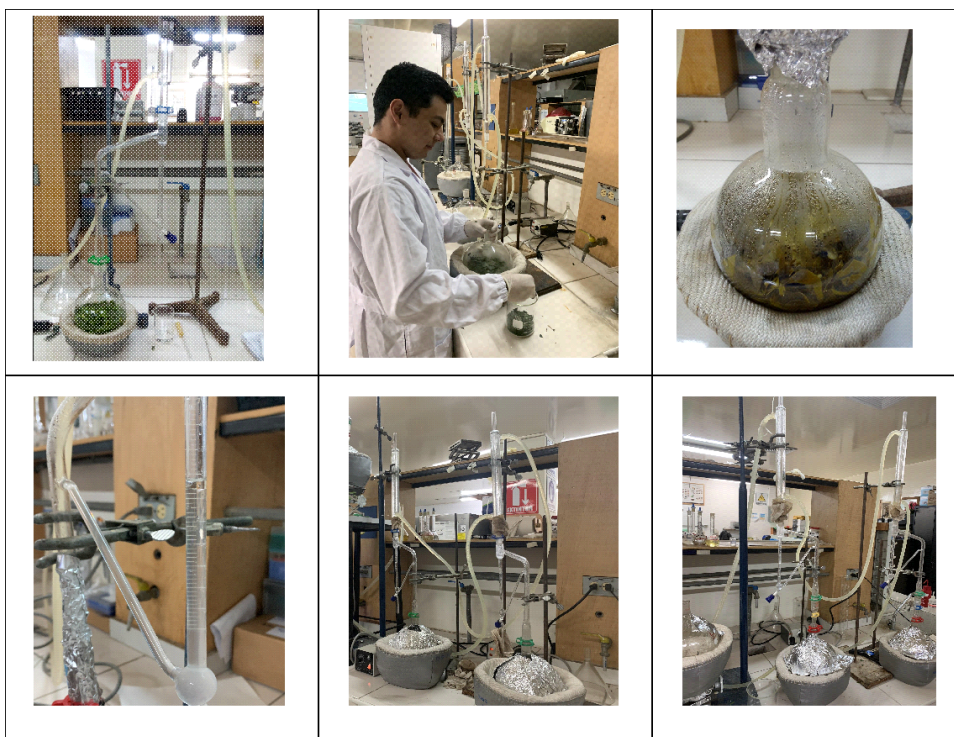
Fig 9. Extracción de aceites esenciales por Método Clevenger de las especies seleccionadas.
